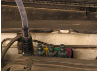
Nachfüllen destilliertes Wasser insbes. im Sommer
