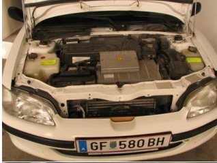
"Motorraum" mit Kühler für Akkus
